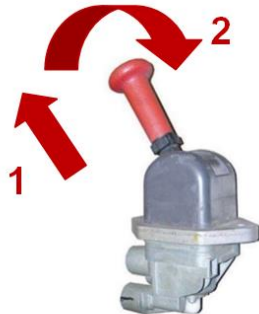
Figura 12.30. Válvula de freno de estacionamiento.
