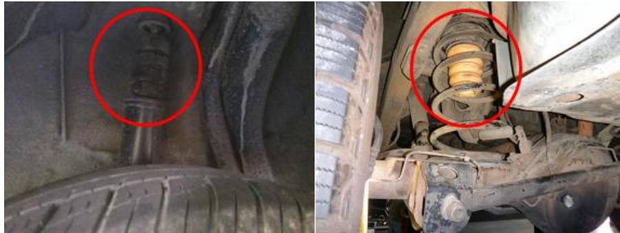
Topes de suspensión ubicados en el amortiguador y muelle
